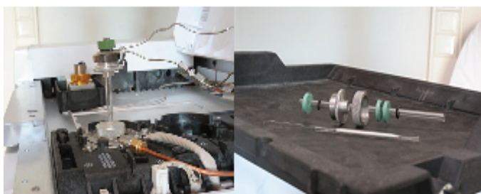
Obr.1: Upravený dávkovací priestor prístroja Obr. 2: Mikrokolóna a súčiastky potrebné na 6890 GC – 5972 MSD pre termálnu desorpciu úpravu dávkovacieho priestoru.
