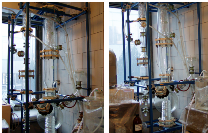
Ľavá strana obrázku ukazuje hornú časť aparatúry s refluxným a dochladzovacím chladičom a napojenie na vzduchotechniku. Pravá strana obrázku ukazuje samotnú reakčnú nádobu s vnútorným regulovateľným ohrevom
